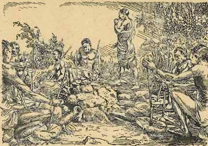
AFF. 7. HOE MEN IN DE BINNENLANDEN VAN AFRIKA WEL IJZER UITSMELT. □ Op de maat van het klappen worden de blaasbalgen bewogen.
