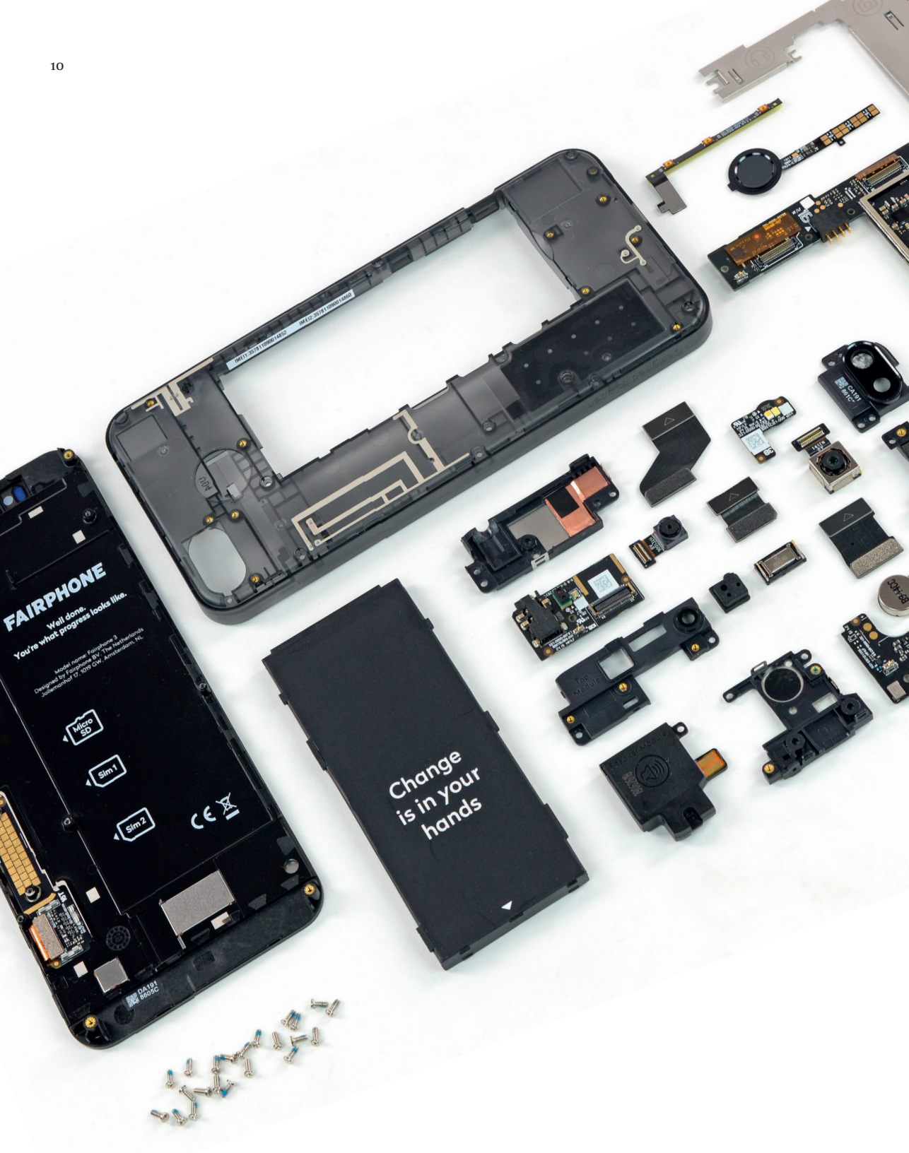
De Fairphone is zo gemaakt dat gebruikers deze zelf kunnen repareren. Online kunnen onderdelen worden nabesteld.
