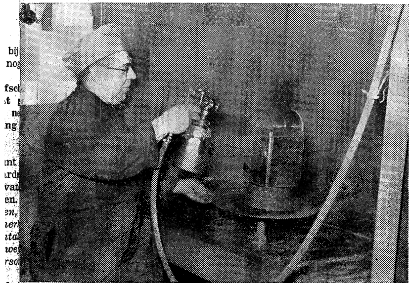
Afbakeningslantaarns worden vakkundig in Dordt gespoten.
